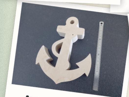
Ancre en comblanchien, épaisseur 40 mm
